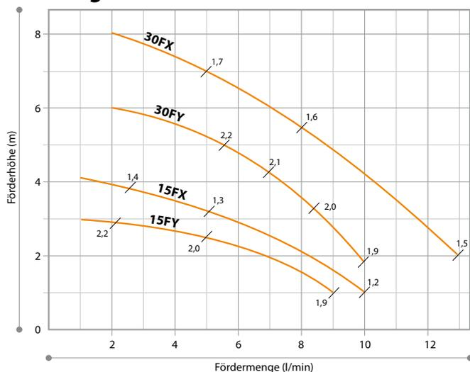
Bem.: Die Werte an den Leistungskurven zeigen das max. spezifische Gewicht bei einer Viskosität von 1 mPas bzw. cP.
